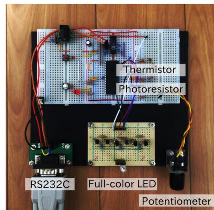
今回使用しているLEDはカソードコモンであるため、ドライバ回路は負論理で構成しています。即ち、制御用のポートがLowレベルのときLEDが点灯し、制御用のポートがHighレベルのときLEDが消灯します。
